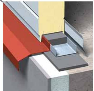
Dole; vnější a vnitřní oplechování základny. 25 mm silné těsnění uvnitř kolejničky monowall a 10 mm těsnění vespad kolejničky. Na vnitřní straně vnitřek oplechování krytu základny.
