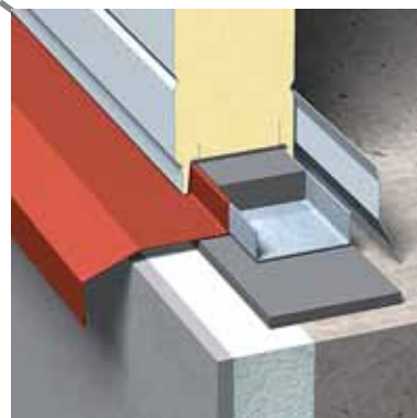
Dole; vnější a vnitřní oplechování základny. 25 mm silné těsnění uvnitř kolejničky monowall a 10 mm těsnění vespad kolejničky. Na vnitřní straně vnitřek oplechování krytu základny.
