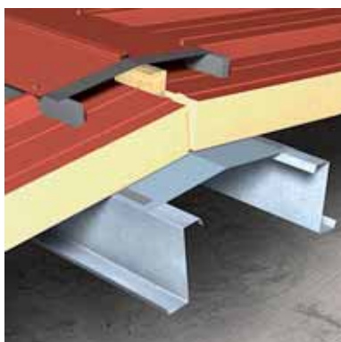
Detail hřebene standardního provedení. Důležitými elementy jsou dvojí těsnění a těsnící pásky, spodní a vrchní hřeben, izolační vložka hřebenového styku panelů
