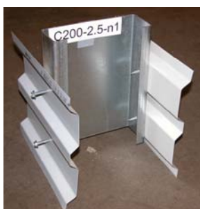
3.3 ábra: Együttdolgozó kapcsolat kísérleti vizsgálata.
