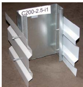
3.3 ábra: Együttdolgozó kapcsolat kísérleti vizsgálata.
