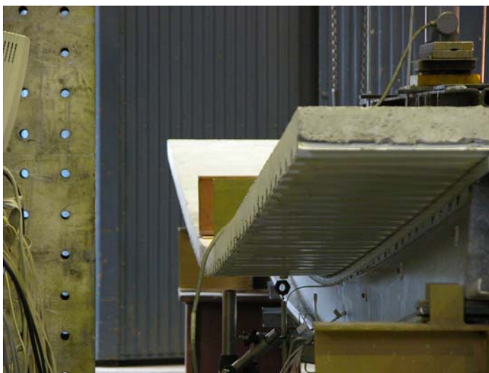
3.4 ábra: Öszvérgerenda kísérleti vizsgálata.
